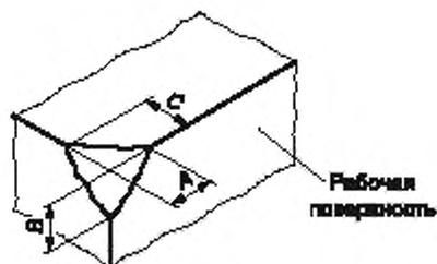
Рисунок 4 — Измерение отбитости угла
