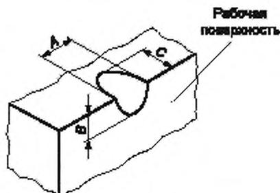
Рисунок 3 — Измерение отбитости ребра
