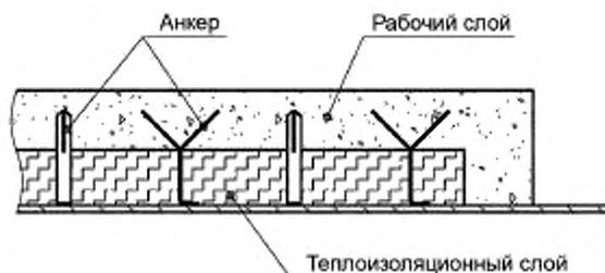
Рисунок 2 — Конструкция торцов комбинированной футеровки
