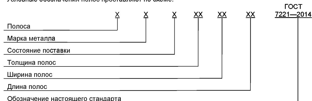
При этом используют следующие сокращения для обозначения состояния поставки: М — мягкое, Т — твердое.
